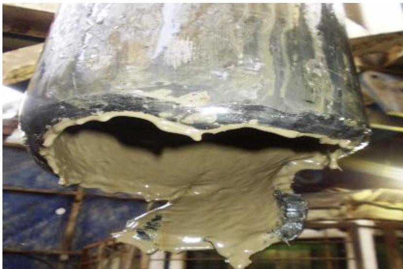
Рисунок 3 - Инструмент после торпедирования
