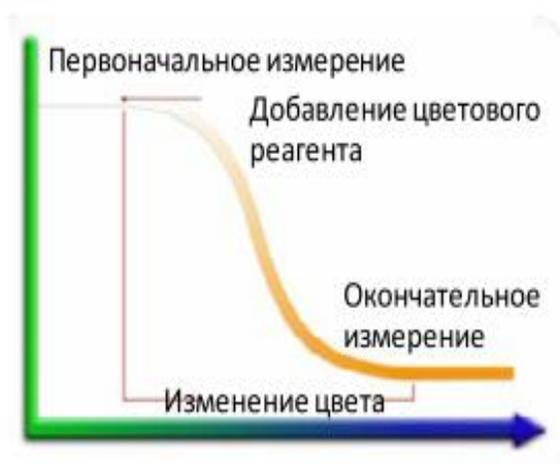
Рисунок 8 - Цикл работы поточного анализатора
