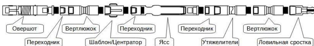
Рисунок1 - Схема ловильного оборудования
