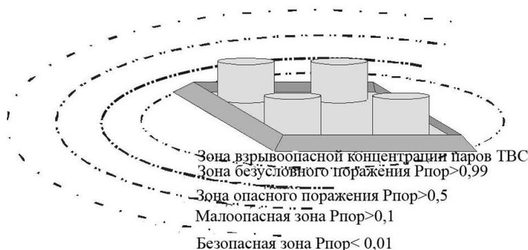
Рисунок 3 — Принципиальная схема зонирования опасных зон при взрыве паров ТВС в открытом пространстве
