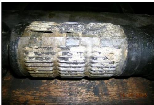
Рисунок 2 - Засорение приемной сетки
