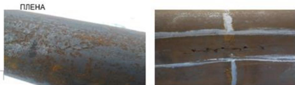
Рисунок 2 - Дефекты на внешней поверхности трубы
