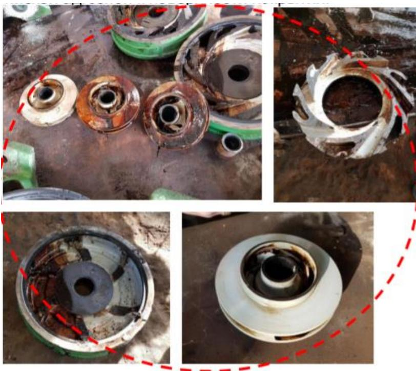
Рисунок 4 - Внешний вид деталей насоса с полимерным покрытием
