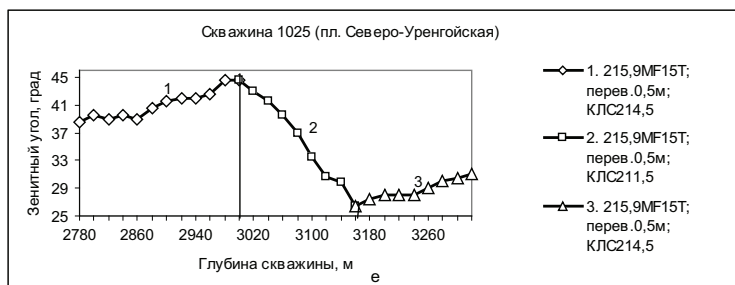
Рис. 6.1. Изменение зенитного угла по глубине скважины при бурении компоновками с калибратором
