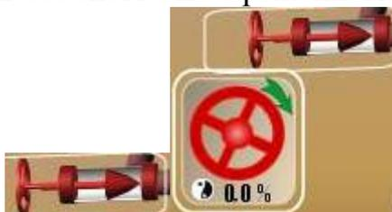
Превенторы, пробковые краны, стопоры пробок и задвижки управляются кликом мыши. Одно нажатие левой кнопки мыши над изображениями этих элементов переводит их в противоположное предыдущему состояние.
