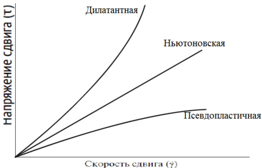
Рис. 3.9. Реологические кривые, соответствующие различным классификациям жидкостей
