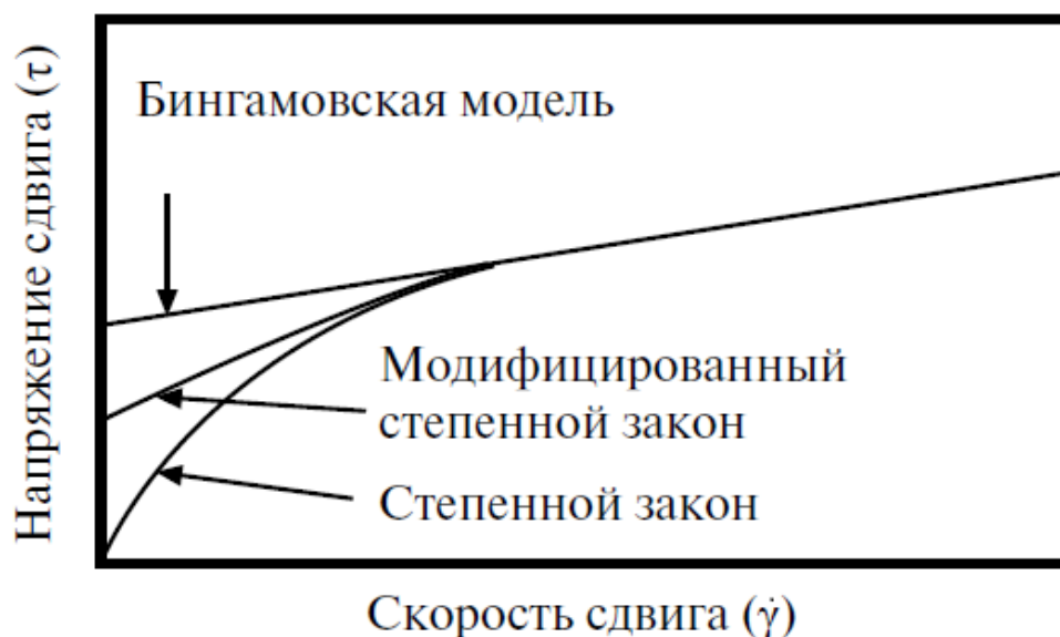
Рис. 3.11. Сравнение реологических кривых для бингамовской, степенной и Гершеля – Балкли моделей
