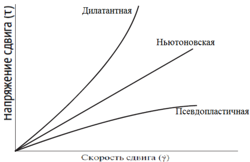
Рис.3.9. Реологические кривые, соответствующие различным классификациям жидкостей
