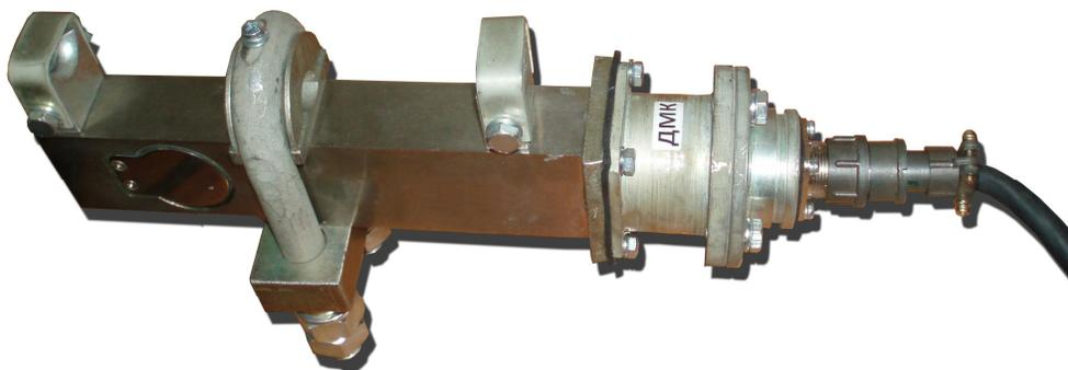
Рис. 12. Внешний вид датчик крутящего момента (ДМ)
