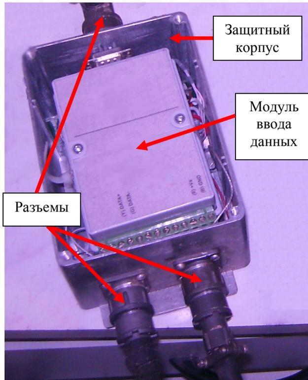
Рис. 24. Внешний вид блока сопряжения
