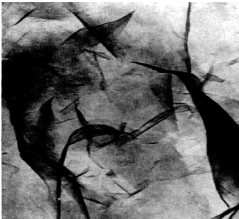
Электронно-микроскопический снимок монтмориллонита (увеличение в 87,5 тыс. раз)
