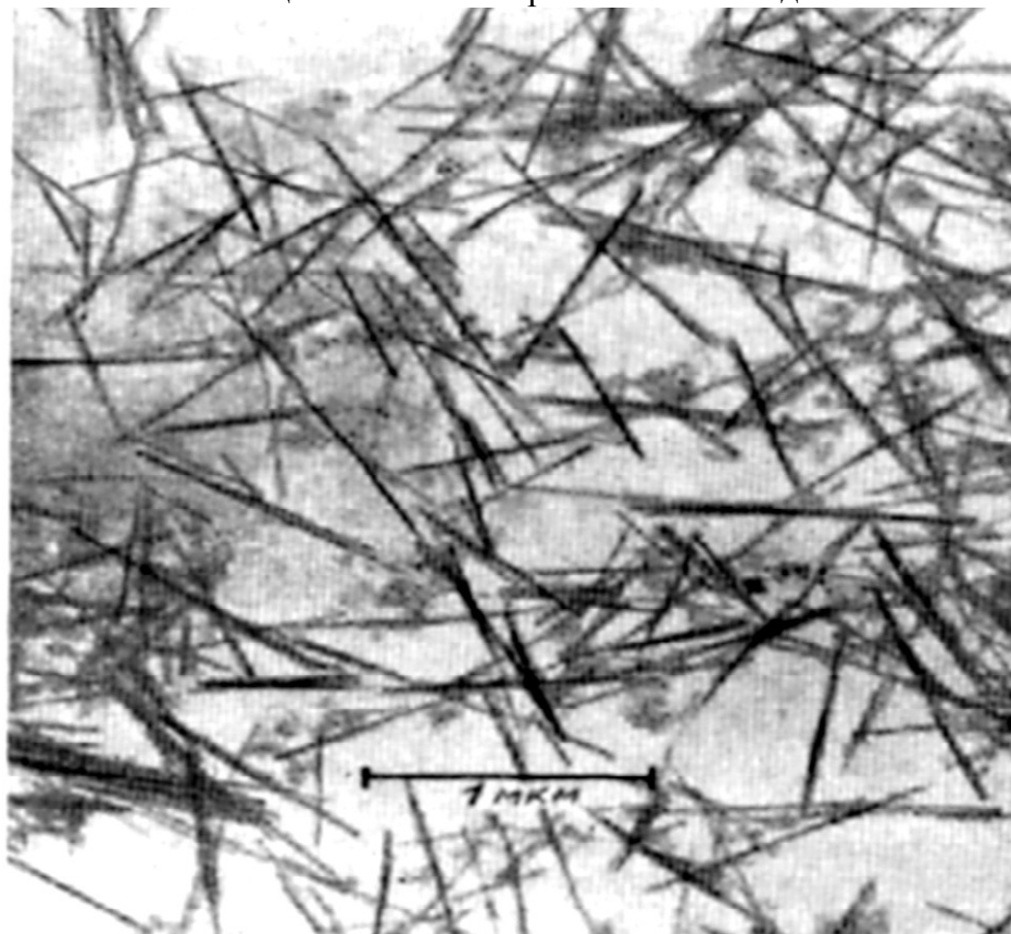
Электронно-микроскопический снимок аттапульгитовой глины с открытосетчатой структурой (увеличение в 45 тыс. раз)
