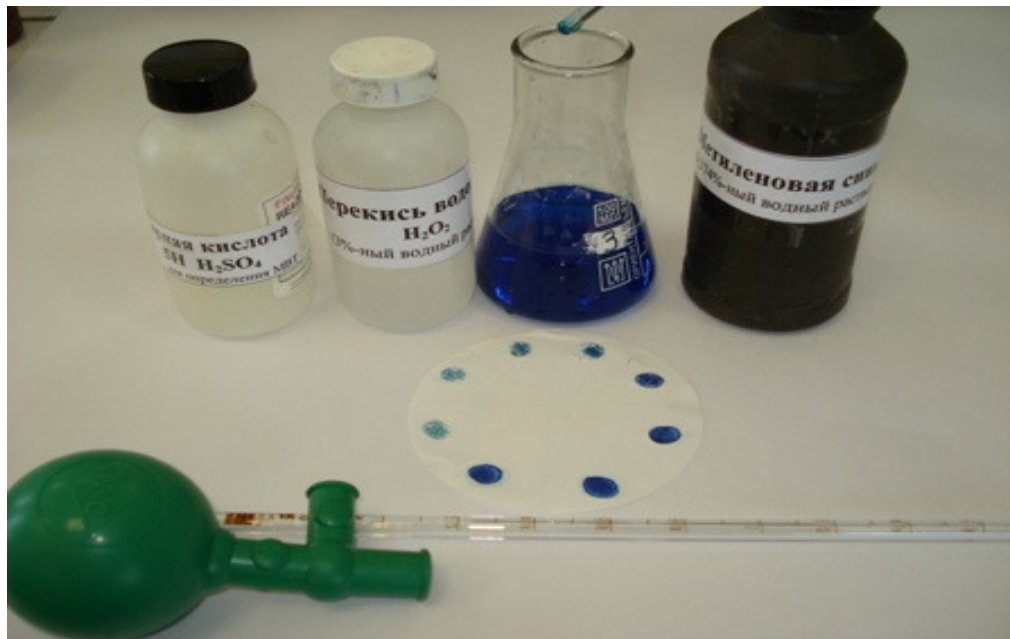
Рис. Титрование раствором метиленовой сини
