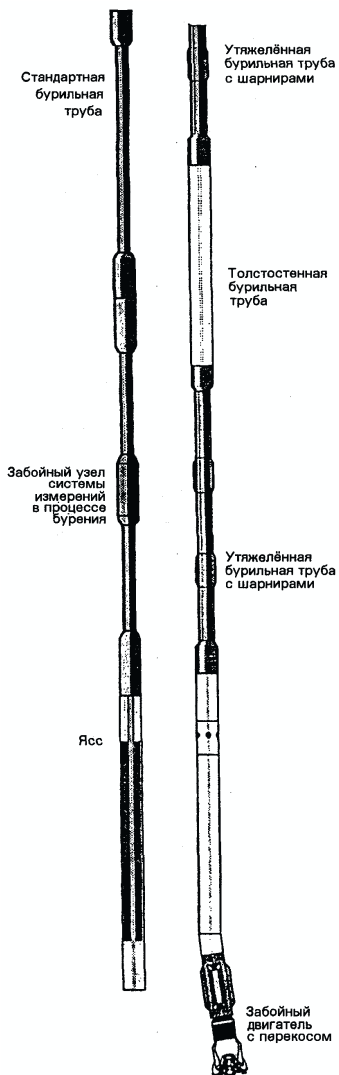
Рисунок 54 – Компоновка с забойным двигателем с одним перекосом
