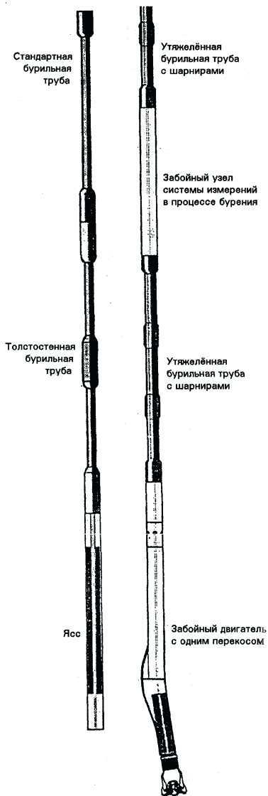
Рисунок 58 – Компоновка с забойным двигателем с одним перекосом для среднего угла
