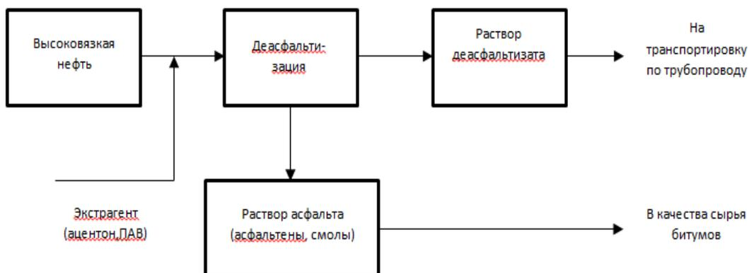
Рис. 1. Схема деасфальтизации высоковязкой нефти
