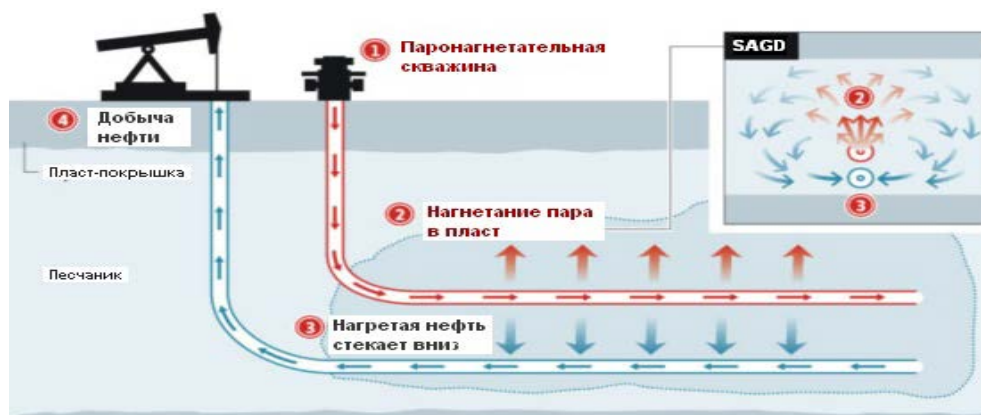
Рис 5. Парогравитационное дренирование пласта
