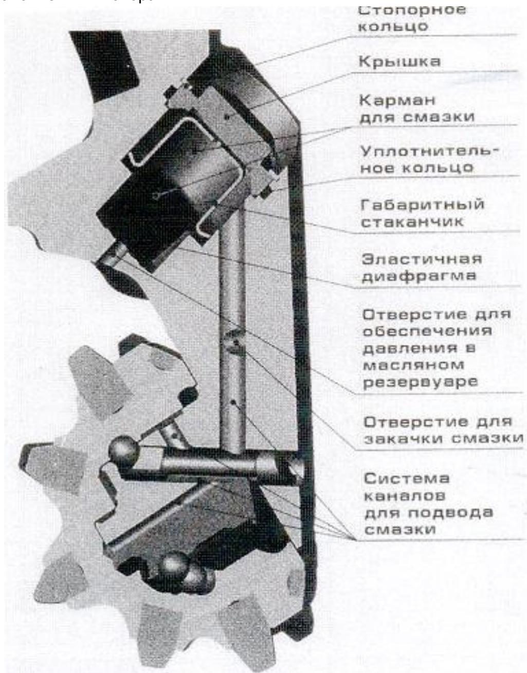
Рисунок 3.84а - Устройство долота с новой схемой лубрикатора
