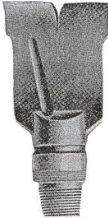
Рисунок 3.6 - Долото типа РХ с верхней промывкой
