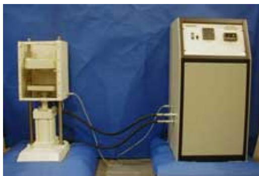
Рисунок 22 - Модель Chandler Engineering 4207D (цифровой) тестера прочности на сжатие.
