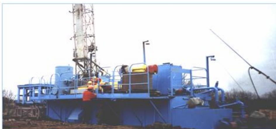
Рисунок 8.4 - Малогабаритная циркуляционная система НПО «Бурение»
