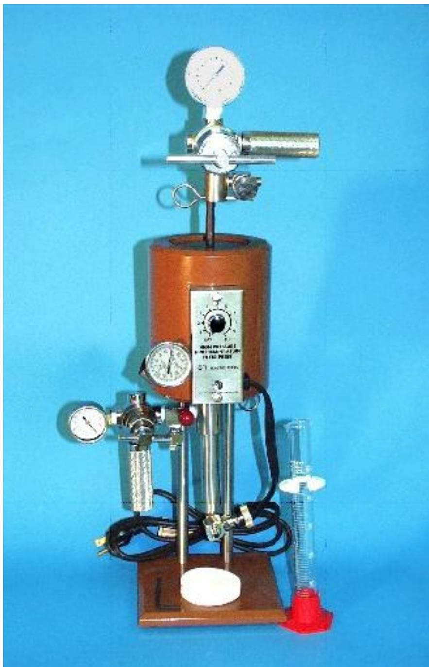
Рисунок 4.19 Фильтр-пресс высокого давления и температуры
