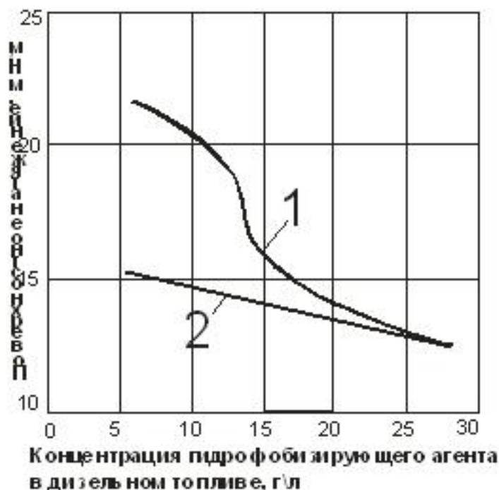
Рисунок 2.12 - Влияние адсорбции частицами глинистого сланца гидрофобизирующего агента из углеводородной фазы на изменение поверхностного натяжения дизельного топлива на границе с водой: 1 - 85,6 г/л глинистого сланца глен роуз; 2 - глинистый сланец отсутствует
