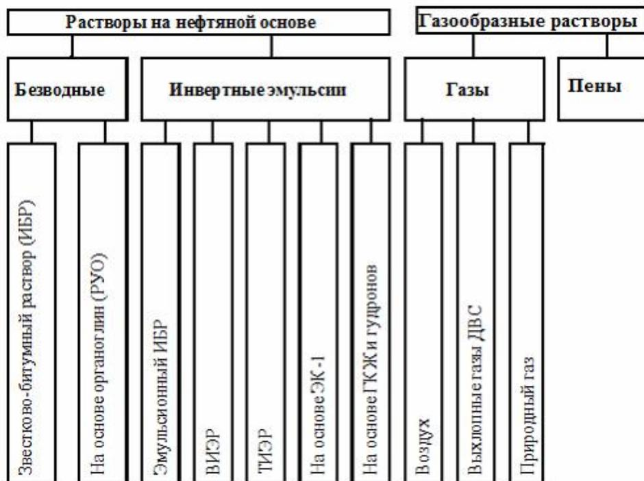
Рисунок 5.2 - Классификация буровых промывочных жидкостей (растворы на нефтяной основе и газообразные растворы)
