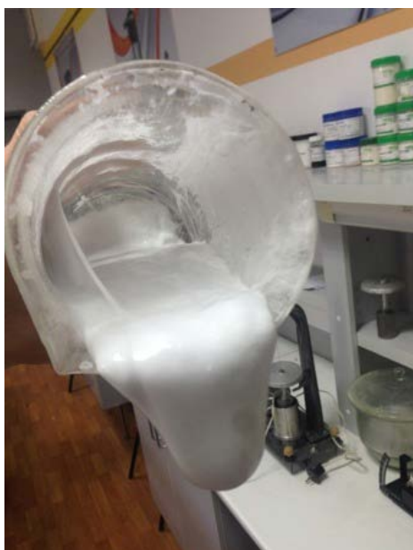
Рис. 3 – Фотография отвержденного ВУС с колюматантом
