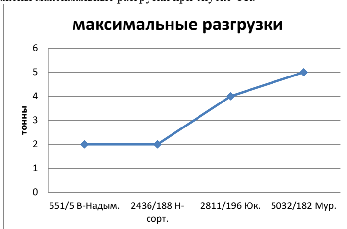
Рис.2 Разгрузки при спуске ОК в открытый ствол, при подъеме КНБК после проработки с циркуляцией и вращением.
