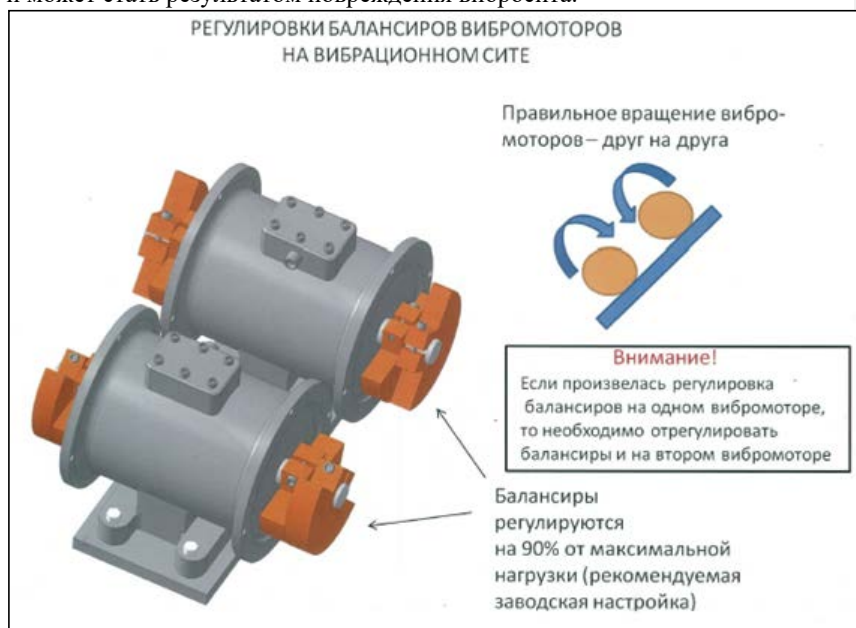
Рис. 5. Регулировка балансиров вибромоторов на вибрационном сите.
