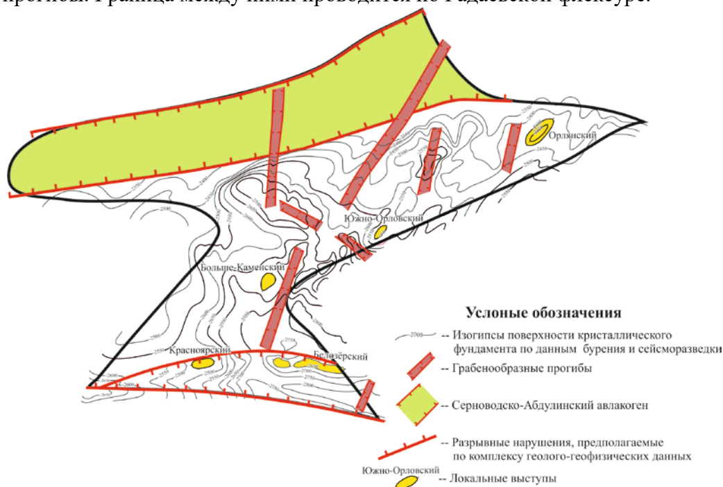
Рис. 4. Фрагмент схематической карты поверхности кристаллического фундамента Сокской седловины
