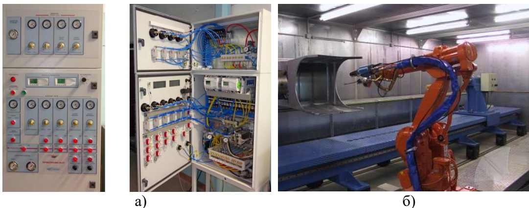
Рис. 5. Промышленная установка плазменного напыления. а – пульт управления установкой; б – плазматрон.
