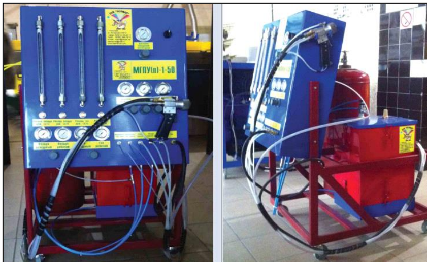
Рис. 7. Передвижная установка для напыления защитных покрытий
