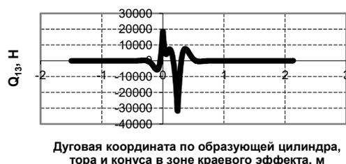
Рис. 6. Зависимость между расстоянием от стыка торовой и цилиндрической частей сосуда, и поперечной силой  $Q_{13}$
