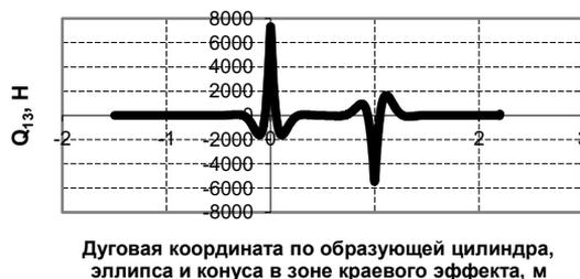
Рис. 12. Зависимость между расстоянием от стыка эллипса с цилиндром и поперечной силой  $Q_{13}$
