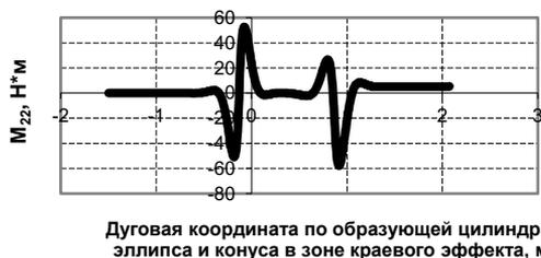
Рис. 11. Зависимость между расстоянием от стыка эллипса с цилиндром и кольцевым изгибающим моментом  $M_{22}$
