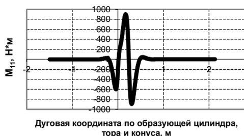
Рис. 4. Зависимость между расстоянием от стыка торовой и цилиндрической частей сосуда, и меридиональным изгибающим моментом  $M_{11}$
