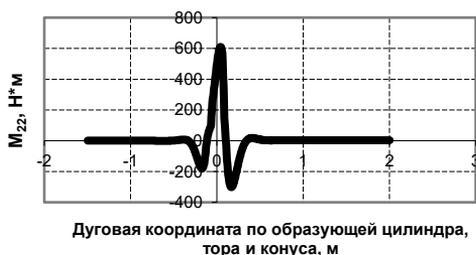
Рис. 5. Зависимость между расстоянием от стыка торовой и цилиндрической частей сосуда, и кольцевым изгибающим моментом  $M_{22}$
