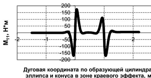
Рис. 10. Зависимость между расстоянием от стыка эллипса с цилиндром и меридиональным изгибающим моментом  $M_{11}$
