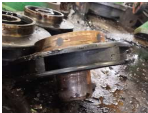
Рис 5. Разбор ЦНС 60х300 с полимерными рабочими колесами Нароботка 1676 часов. Отложения на рабочих органах отсутствуют.
