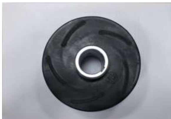
Рис 4. Рабочее колесо, изготовленное из полимерного материала
