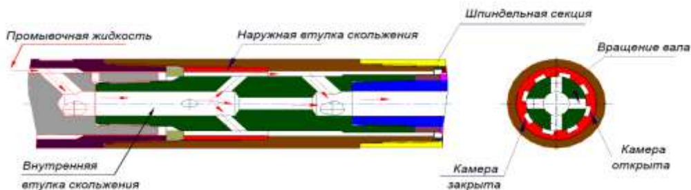
Рисунок 2. - Принцип работы, модуля генератора импульсов давления
