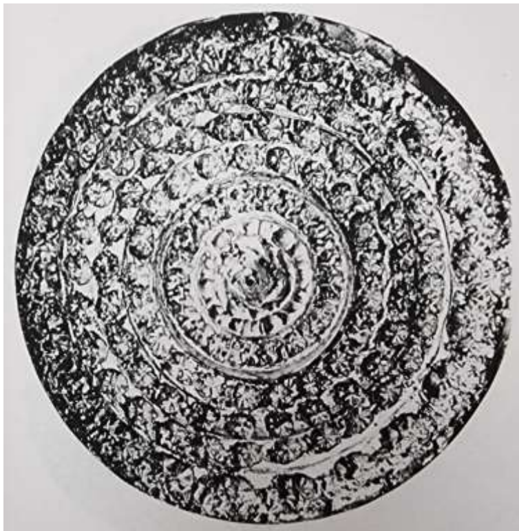
Рис. 6. Образование «рейки» на забое от применения долота 215,9 мм. для бурения средних абразивных пород, с шарошками, оснащенными твердосплавными зубками СЛ.
