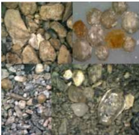
Рис 1. Шлам неизменной породы пласта А4 башкирского яруса. Известняк серого с бурым иногда светло-кремовым оттенком, цвета, биосфероагрегатный (частично псевдооолитовый) мелкозернистый пористый, средней крепости.
