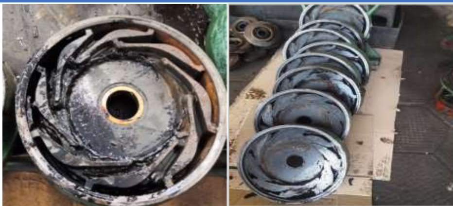
Рис 1. Разбор ЦНС 60х330 со стальными рабочими колесами. Нароботка 368 часов. Отложения на рабочих органах составляют 99 %.
