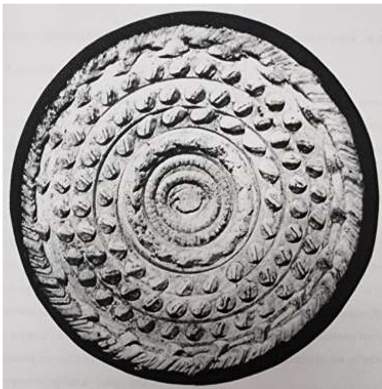
Рис. 2. Развитие рейки на забое от базового долота 215,9 СЗ для бурения средних абразивных пород, с постоянной ориентацией лезвий клиновидных зубков на венцах шарошек.
