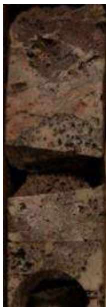
Рисунок – 5 б) Доломит разнокристаллический, перекристаллизованный, слабо глинистый, ожежененный. Пустоты 0,01 – 5 см. Скв Юр – 304, глубина 2616,20 м
