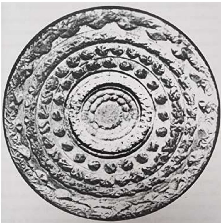
Рис. 4. Возникновение измененной «рейки» на забое при работе долота 215, СЗ.
