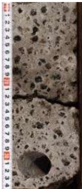
Рисунок – 5 а) Мелко – тонкокристаллический доломит. Пустоты 0,5 – 1 см. Скв Юр – 579, глубина 2578,90 м
