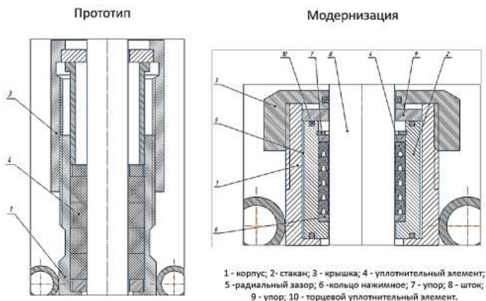
Рис 1. - Сравнительный анализ прототипа и модернизированной конструкции устьевого сальника.
