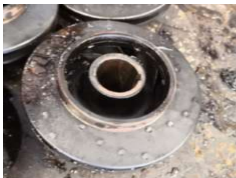
Рис 5. Разбор ЦНС 60х300 с полимерными рабочими колесами Нароботка 1676 часов. Отложения на рабочих органах отсутствуют.
