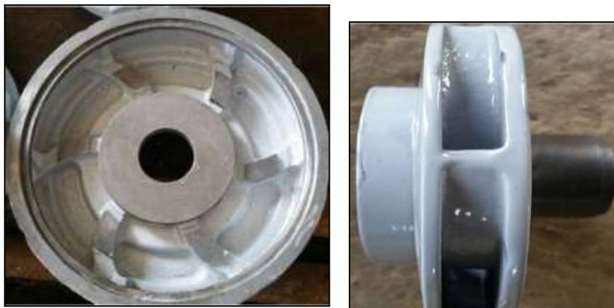
Рис 6. Сборка насоса ЦНС 60х330 с нанесенным полимерным покрытием
