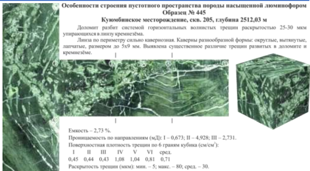
Рисунок – 5 Пример капиллярной дефектоскопии по К.И Багринцевой
