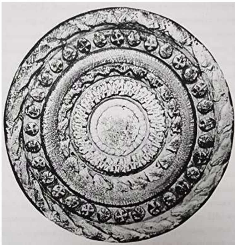
Рис. 8. Образование «рейки» на забое от применения долота 215,9 мм. для бурения твердых и твердокрепких пород, с шарошками, оснащенными твердосплавными крестовидными зубками, с четырьмя сходящимися на вершине клиновидными лезвиями (КРЗ).
