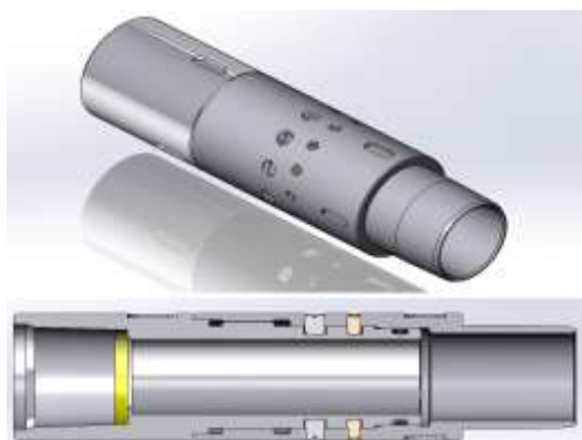
Рис. 1. Первый вариант переводника с растворимыми штифтами
