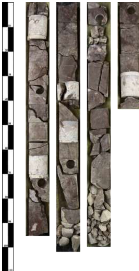
Рисунок – 4 Пример спиленной колонки керна с местами отбора образцов
