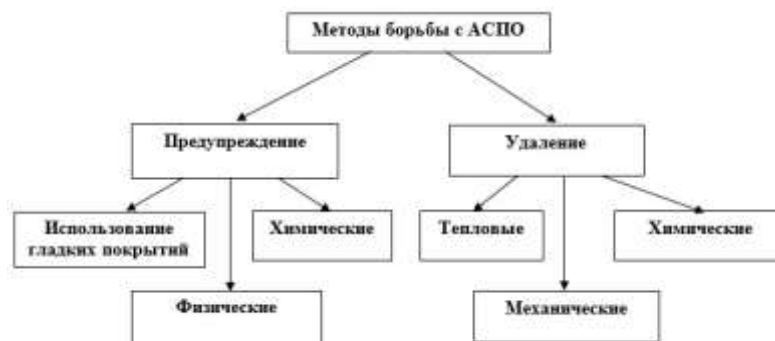
Рис. 2. Схема основных методов борьбы с АСПО
