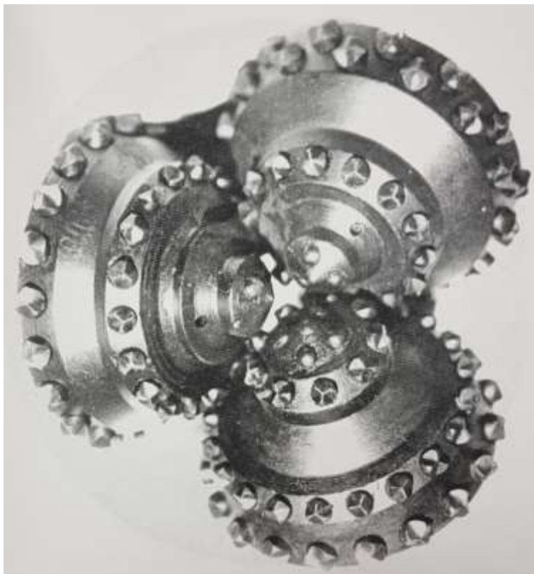
Рис. 5. Буровое шарошечное долото с шарошками, оснащенными твердосплавными зубками с тремя сходящимися клиновидными лезвиями СЛ на вершине.
