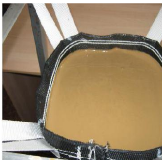
Рис. 4. Геоконтейнерное обезвоживание (лабораторные условия)
