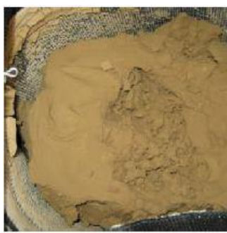
Рис. 4. Геоконтейнерное обезвоживание (лабораторные условия)
