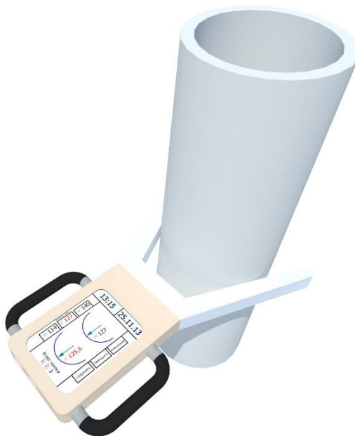
Рис.2 Принцип измерения диаметра трубы с помощью прибора.
