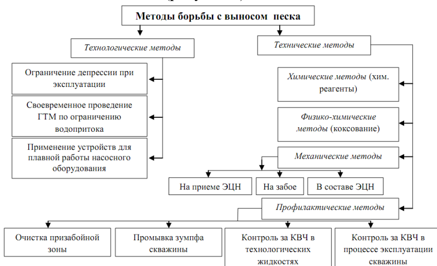
Рис. 2. Методы борьбы с пескопроявлениями в добывающих скважинах
