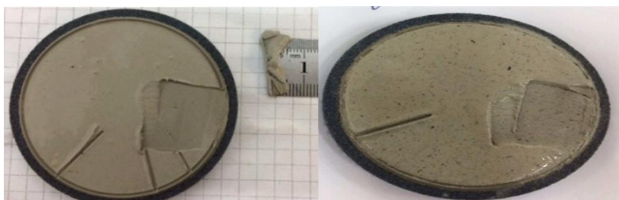
Рис. 8 – Фильтрационные корки буровых растворов, со скважины № 10 (интервал бурения пласта А4)
