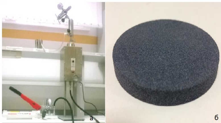
Рис. 2 – а – Прибор PPA, б – керамический диск
