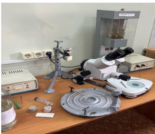
Рис. 4. Установка для измерения краевого угла смачивания
