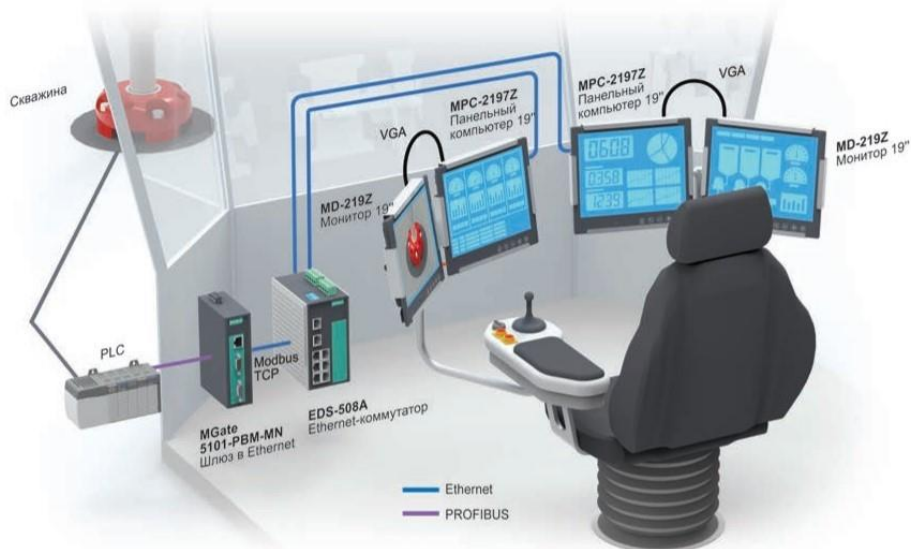
Рисунок 2 – Пульт оператора–бурильщика нового поколения [3]
