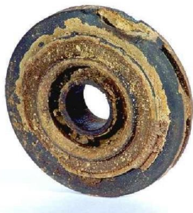
Рисунок 2. Солеотложения на рабочих колесах ЭЦН
