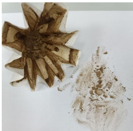
Рисунок 3 – Внешний вид осадка после фильтрации и высушивания при воздействии конверсионным растворителем в динамическом режиме
