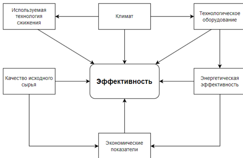
Рисунок 4 - Систематизация областей, влияющих на итоговую эффективность технологического процесса производства СПГ
