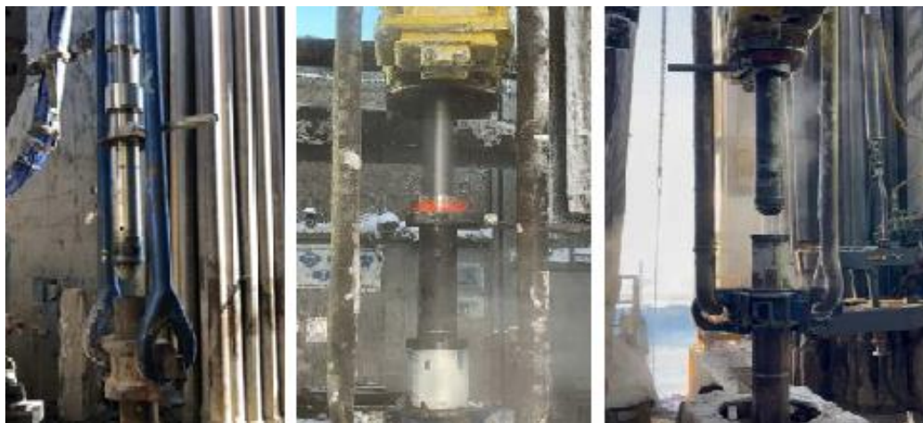
Рисунок 1 – Общий вид системы спуска обсадных колонн casing running tool
