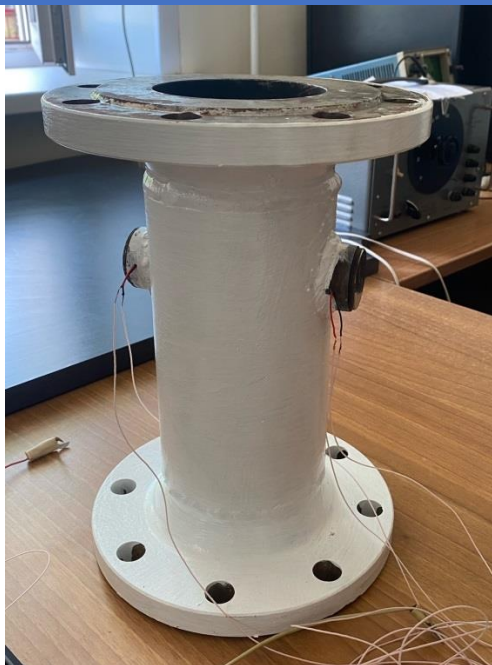
Рис.3 Эскиз измерительного модуля в катушке трубопровода
