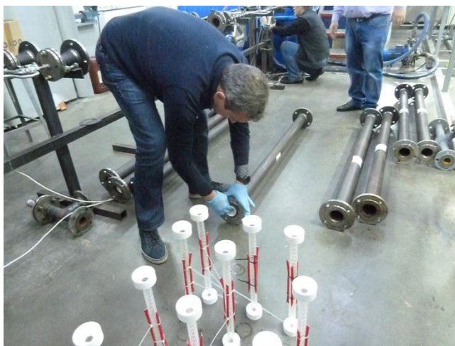
Рис. 7. Установка трассерной системы (нефть+вода+газ) в исследовательские вставки станда
