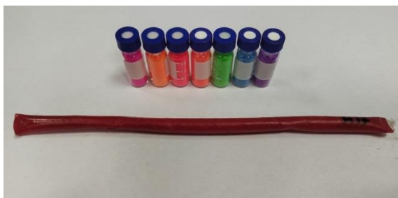
Рис. 5. Образец трассера и композитной трубки для измерения скоростей омывающего потока
