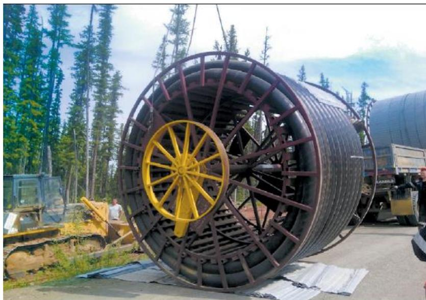
Рисунок 3 – сборка ПАТ на транспортировочном барабане.
