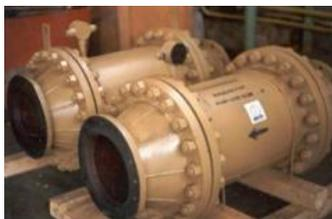
Рисунок 2. Аппарат для магнитно-вихревой обработки.
