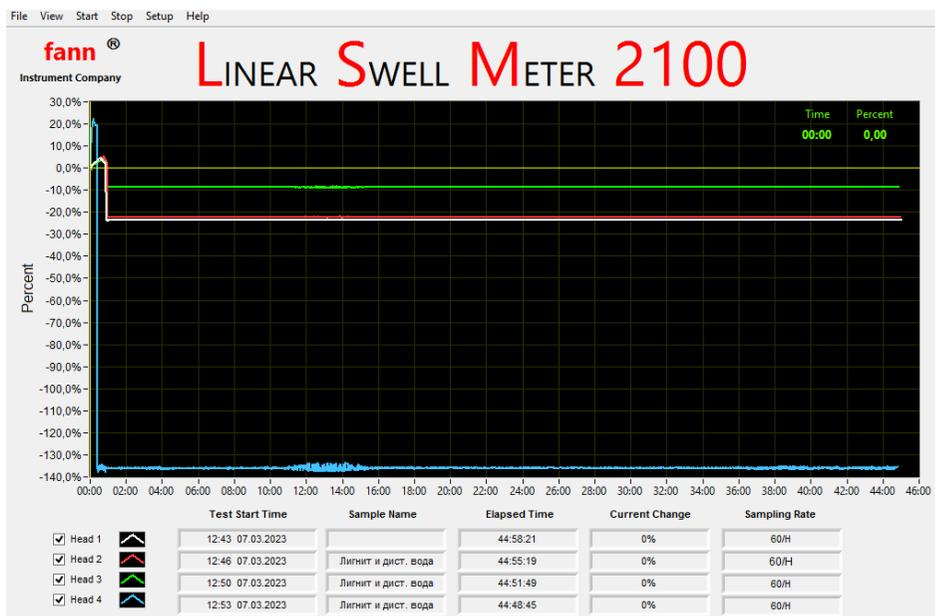
Рис. 5 - Показания прибора LSM 2100 в процессе разрушения искусственно созданных образцов обвальной породы в 1% растворе органофильного лигнита
