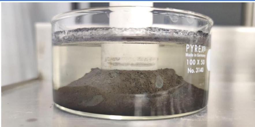
Рис. 4 - Искусственный образец обвальной породы после исследования в 1% растворе органофильного лигнита
