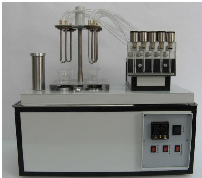
Рисунок 1 – установка для реализации метода холодного стержня
