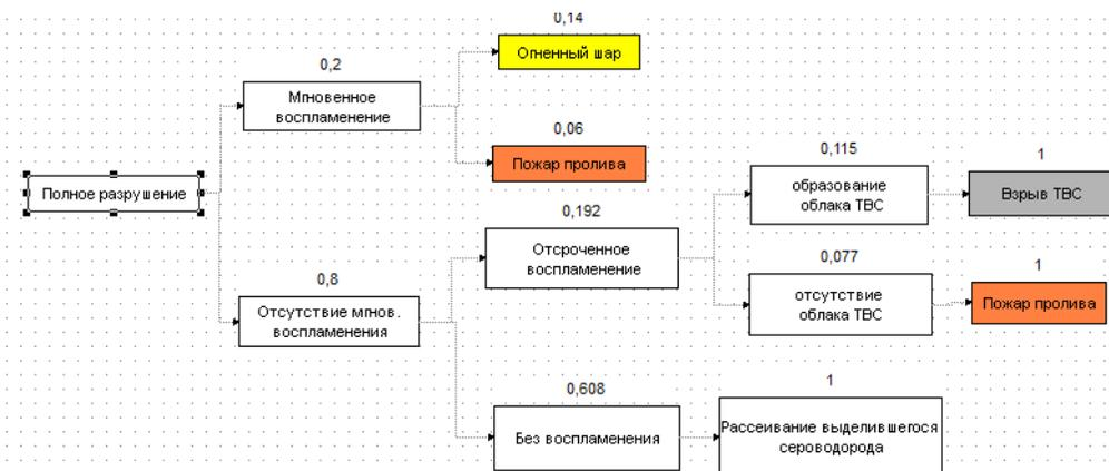
Рис. 3 - Логическая схема развития аварии, связанной с выбросом горячего вещества из газового сепаратора, отстойника
