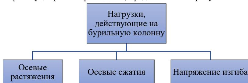
Рисунок 1 - Нагрузки, действующие на бурильную колонну
