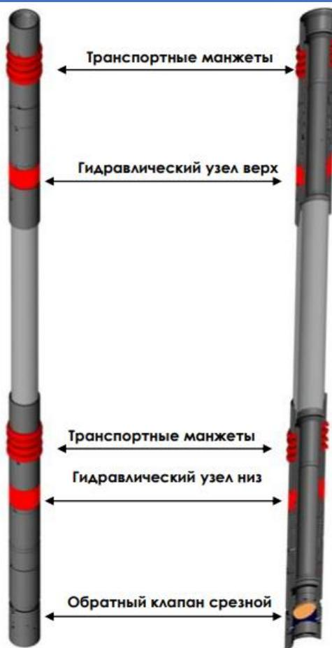
Рисунок 2 Схема устройства изоляции негерметичности НКТ
